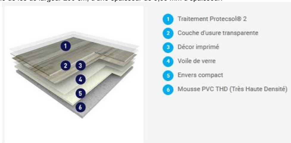
Figure 1 : illustration du principe de fabrication du produit Taralay Impression Confort
