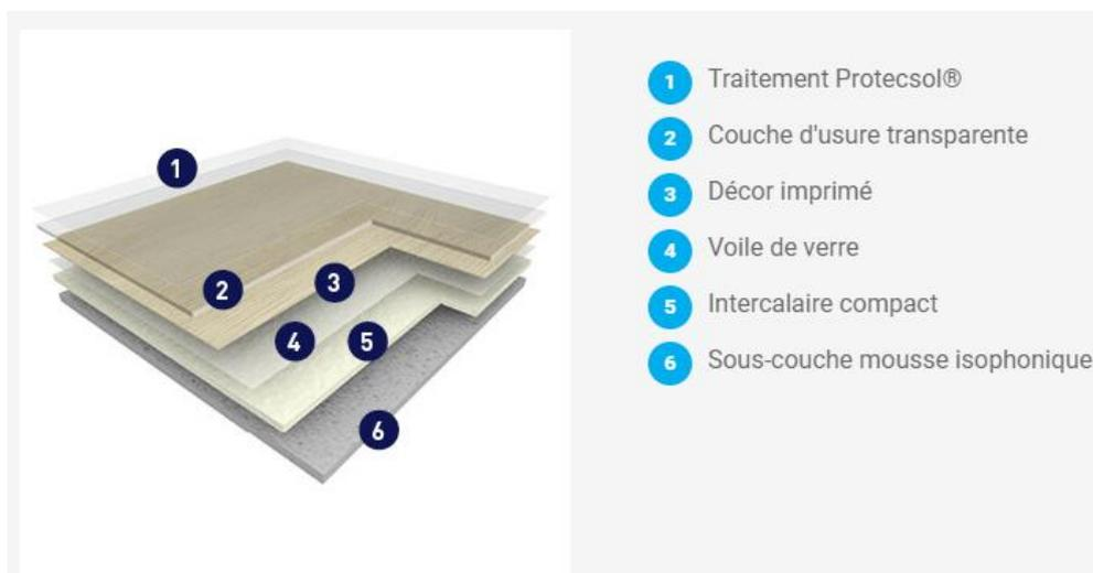
Figure 2 : illustration du principe de fabrication du produit Taralay Initial Confort
